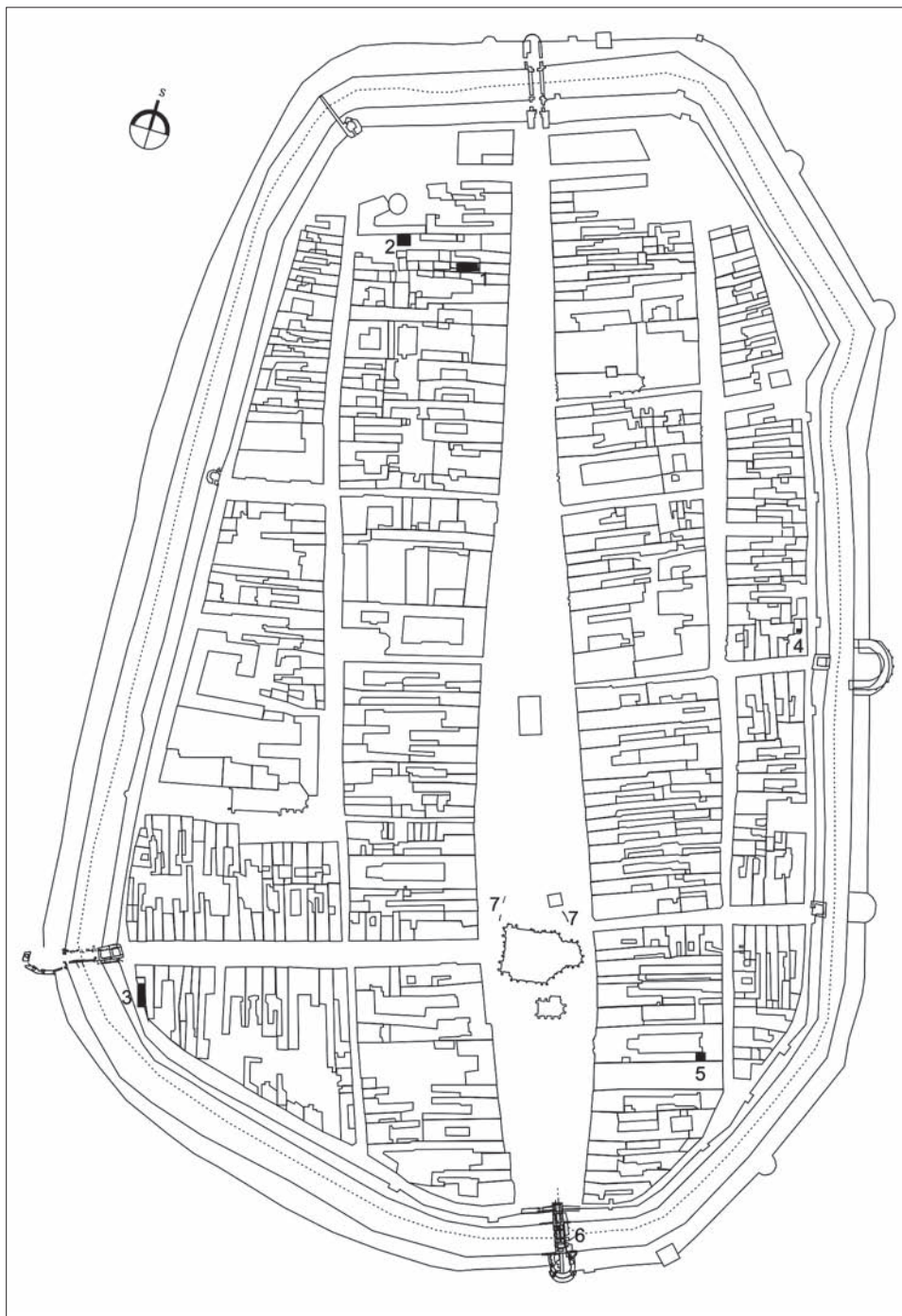
Obr. 1. Košice. Nálezy drevených stavebných konštrukcií z obdobia stredoveku v historickom jadre mesta. 1 – Hlavná 96; 2 – Mäsiarska 57/A; 3 – Alžbetina 36; 4 – Pri Miklušovej väznici 10; 5 – Hlavná 27; 6 – Dolná brána; 7 – Hlavná ul., nám. severne od Dómu.
