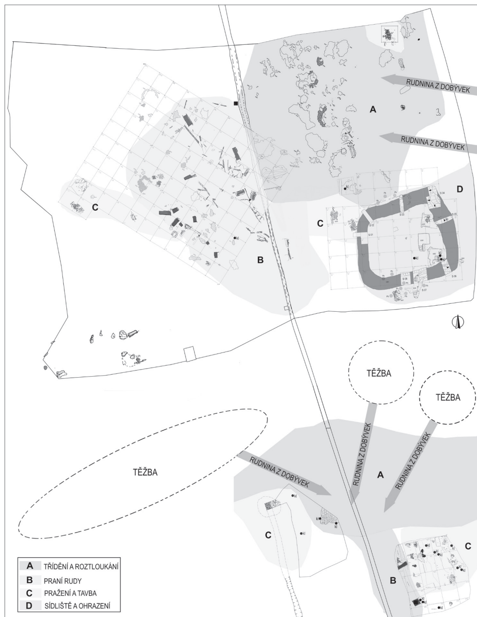
Obr. 7. Plošně zkoumaný montánní areál Cvilínek (ZAV 2009–2010) s rozlišením pracovní infrastruktury.
