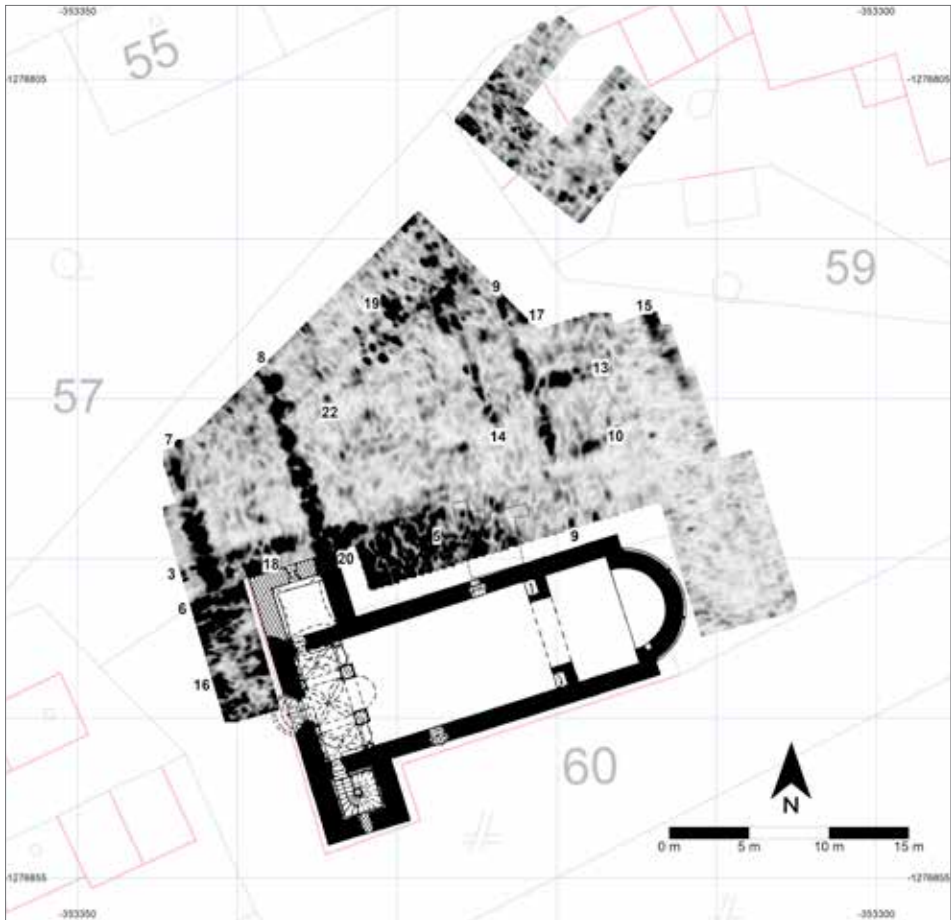
Obr. 8. Rimavské Janovce. Výsledky merania GPR. Hĺbková úroveň rezu 1 m. Abb. 8. Rimavské Janovce. Ergebnisse der GPR-Messung. Tiefenniveau des Schnitts 1 m.
