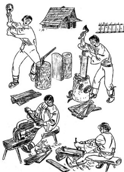
Obr. 7. Postup výroby šindele na Valašsku. Kresba J. Kobzáně.
