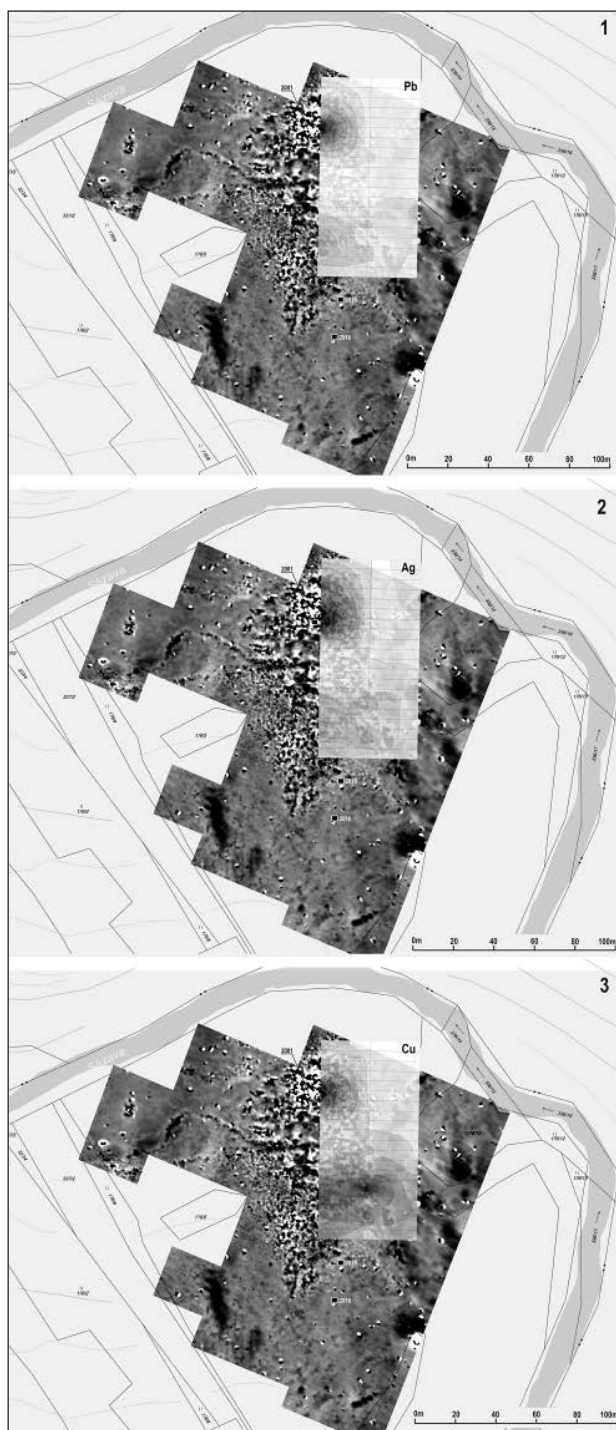
Obr. 88. Zákrut Sázavy u Utína. Kombinace datových vrstev s geomagnetickými anomáliemi a geochemickými anomáliemi těžkých kovů (Pb, Ag, Cu). Analýza P. Kadlec (Ústav geologických věd PřF MU), zpracování dat K. Malý. Podklad převzat z Geoportálu ČÚZK, Katastrální mapy. Geomagnetické měření P. Milo, ÚAM FF MU (Hrubý a kol. 2016).
