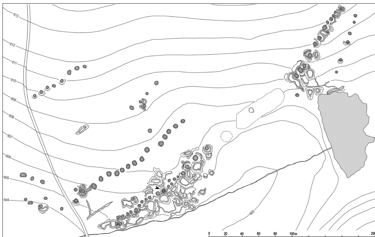
Obr. 47. Středověká hornická lokalita u Opatova (okr. Jihlava) v pelhřimovském revíru. Zaměření jámových a odvalových tahů s vyznačením zkoumané šachty s výdřevou. Zaměření pomocí GPS autor.
