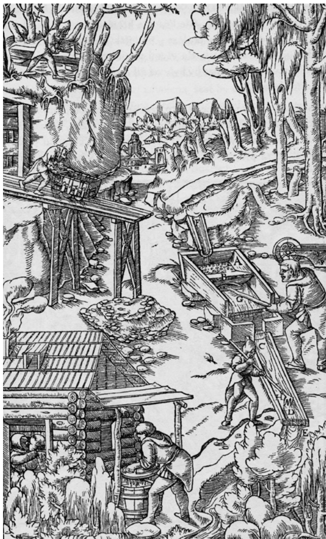
Obr. 36. Rýžovnické pracoviště v díle G. Agricoly (převzato z: Ježek-Hummel 2001)
