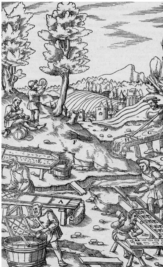
Obr. 35. Rýžovnické pracoviště v díle G. Agricoly (převzato z: Ježek-Hummel 2001)
