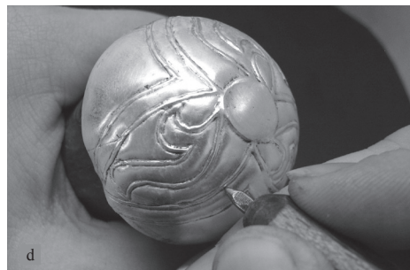
Obr. 6. Zhotovení repliky gombíku. A – vytepávání polokouli; B – předkreslení výzdobného motivu na polokouli; C – rýhování dekoru z vnitřní strany polokoule; D – rýhování z vnější strany polokoule pro vytvoření dvojitéch linek. Foto L. Šejvlová.
