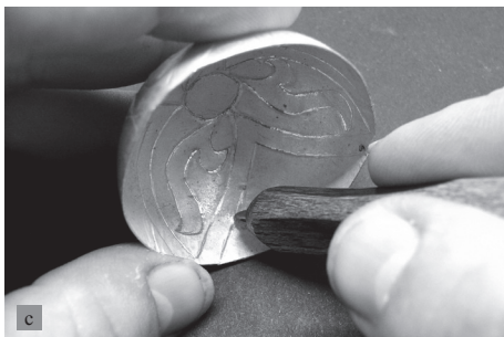
Obr. 6. Zhotovení repliky gombíku. A – vytepávání polokouli; B – předkreslení výzdobného motivu na polokouli; C – rýhování dekoru z vnitřní strany polokoule; D – rýhování z vnější strany polokoule pro vytvoření dvojitéch linek. Foto L. Šejvlová.
