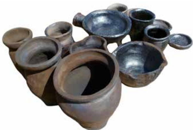
Obr. 7. Část vsádky pece po redukčním výpalu. Vpravo jsou nádoby s natavenými sazemi na povrchu. Foto Pavel Macků.
