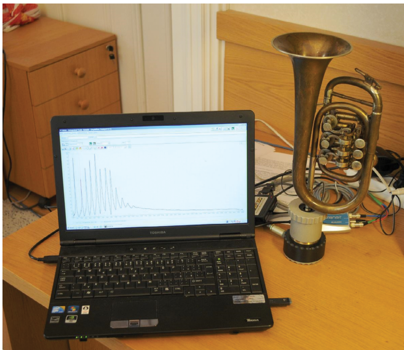
Obr. 4 Šedivův světový kornet (všemirnyj kornet) v hlavě měřicího systému BIAS. Na obrazovce tvar křivky vstupní impedance z konkrétního měření. Foto: Jan Kříženecký, České muzeum hudby.
