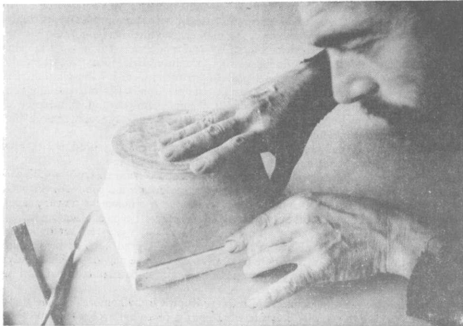
Obr. 3. Homogenizace (spojování) kachlové komory s neprořezanou čelní stěnou, spočívající stále ještě v matrici.
