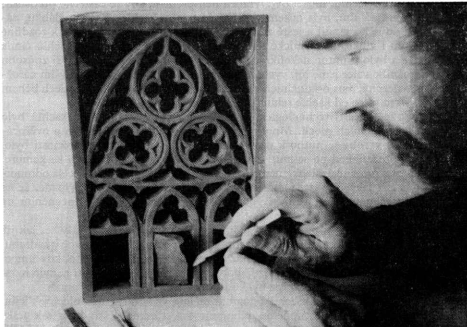
Obr. 5. Konečná fáze prořezávání čelní stěny v jejích dolních partiích.
