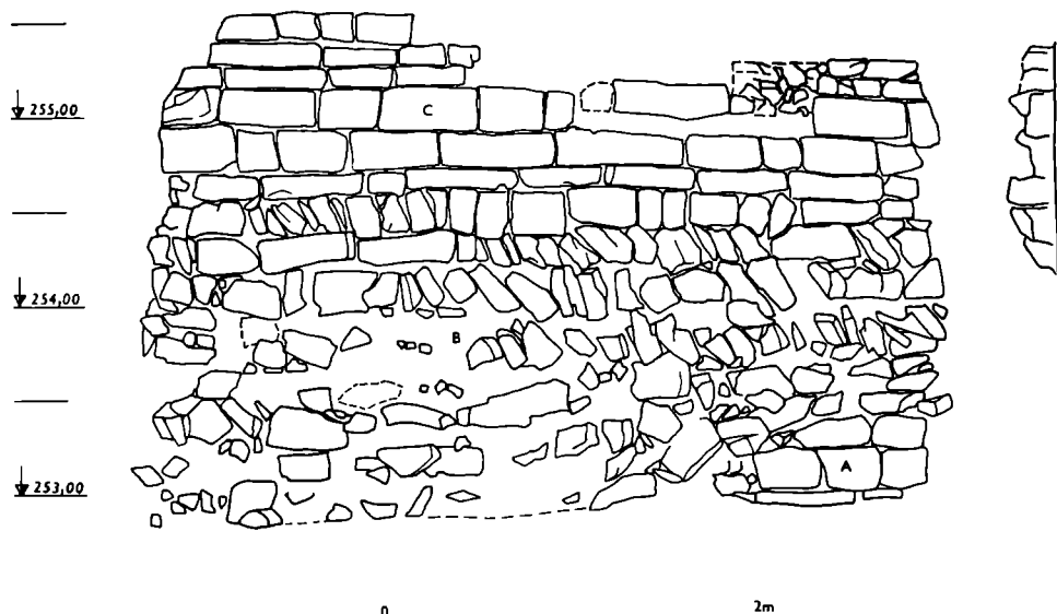
Obr. 6. Pražský hrad — Severní trakt. Prostor někdejších Rudolfových koníren. Kresba V. Richtero- rová. Dochovaná část západního vnějšího líce hradby, obnovovaná kolem poloviny 13. století (C — báze nadzemního zdíva, B — předzáklad) po zřícení části SZ nároží. Původní pravidelný nadzem- ní líc — A — dochován pouze v pravé spodní části.
