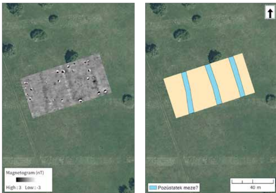
Obr. 3. Výsledky geofyzikální prospekce plochy 1 situované na levém břehu Radějovky. Vlevo magnetogram; vpravo interpretace magnetometru. Autoři Tomáš Tencer, Peter Milo a Michal Vágner.
