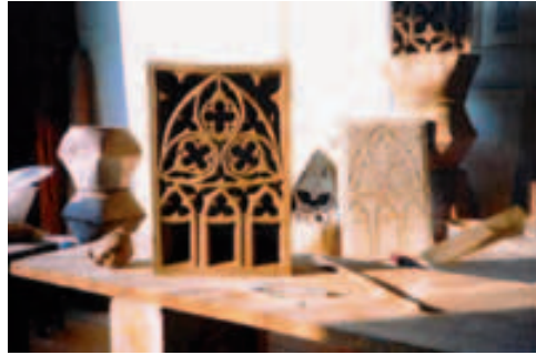
Obr. 3. Rekonstrukce gotického kachle s prořezávanou čelní stěnou – hotový kachel a kadlub, v pozadí kachle připravené k vložení do pece. Foto V. Pařík.
