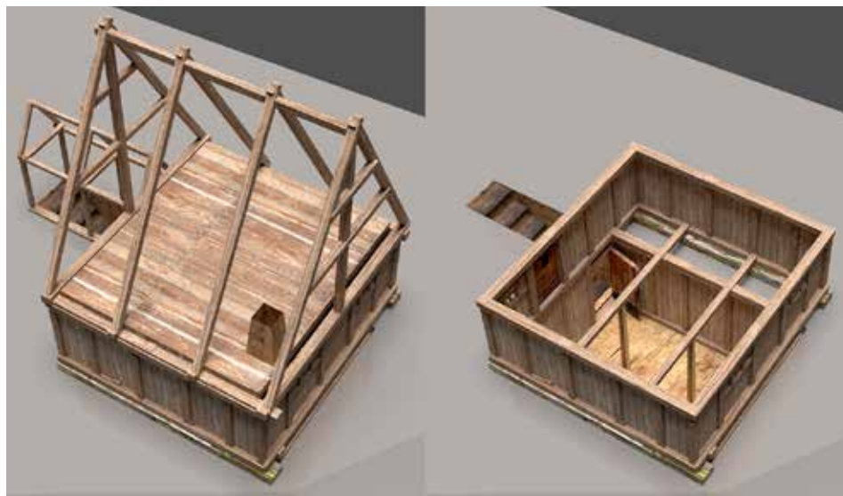
Obr. 24. Kramsirer. Rekonstrukce domu jako malé podsklepené nadzemní stavby se zákopovým stropem a dýmníkem. Podle Derner 2018.
