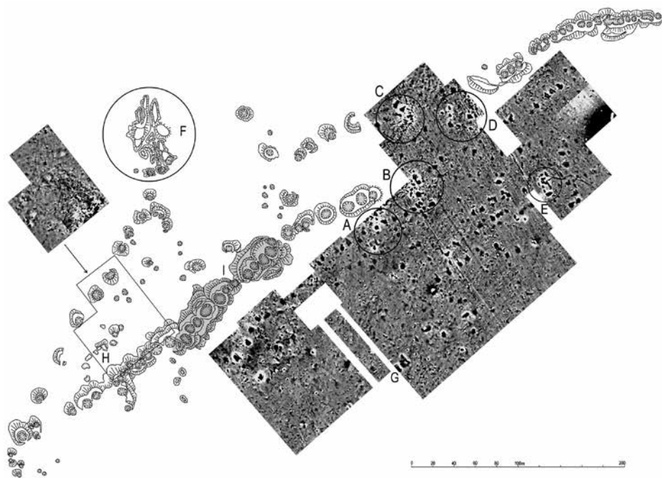
Obr. 3. Zaniklé středověké důlní středisko jižně od Vyskytné. Geomagneticky zjištěné podzemní anomálie interpretované jako sídlištní a další archeologické struktury. A, C–D – magnetické anomálie považované za indikátory kovářských pracovišť; B – geomagnetická anomálie se struskami po hutnictví polymetalických rud; E – geomagnetická anomálie indikující podzemní struktury složitější dispozice; F – konvexní reliéfní tvary související možná s primární úpravou rud; G – geomagnetická anomálie indikující dispozičně složitější podzemní stavební struktury; H – geomagneticky proměřená plocha s výskytem olověných slitků a úkapků a s konkávními terénními tvary, které lze považovat za tzv. zemnice; I – souvislé dolové pole odpovídající středověké důlní míře. Geomagnetické měření ÚAM FF MU.
