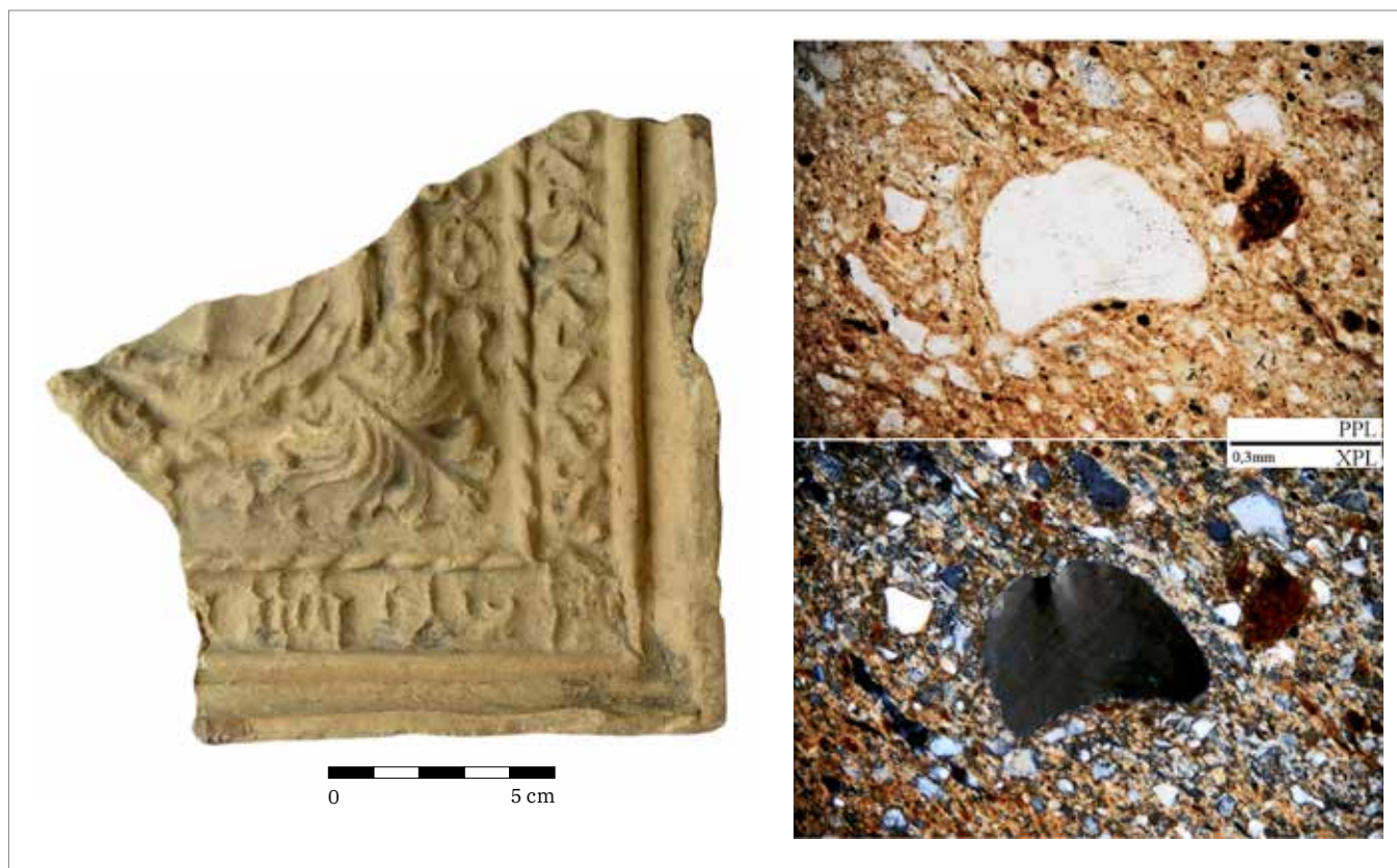
Obr. 11. Cieszyn. 1 – Torzo kachle s motivem provinilého lva (P11, foto V. Nosek); 2 – úlomek křemene v mikrostruktuře keramického střeput, PPL, XPL.
