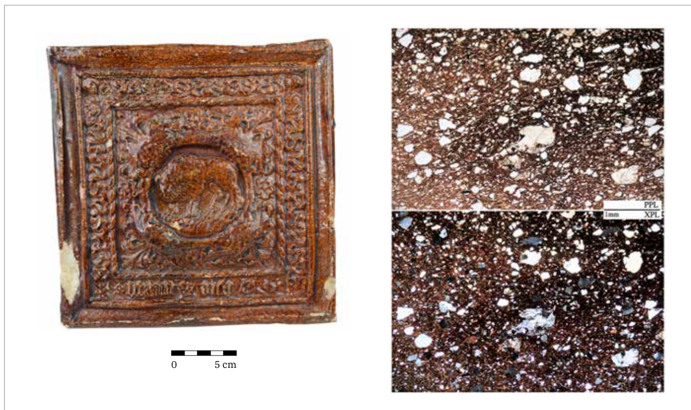
Obr. 7. Olomouc, Barvířská. 1 – Kachel s motivem provinilého lva (P7, foto V. Nosek); 2 – mikrostruktura keramického střepu, PPL, XPL.
