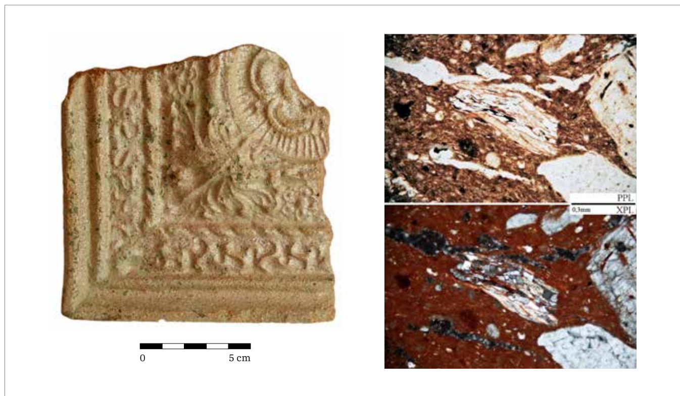
Obr. 14. Dolní Kounice. 1 – Zlomek kachle s motivem rozety rámované klikatkou (P14, foto V. Nosek); 2 – úlomek slídové břidlice v mikrostruktúře keramického střeputu, PPL, XPL.
