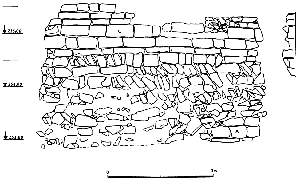
Obr. 6. Pražský hrad — Severní trakt. Prostor někdejších Rudolfových koníren. Kresba V. Richtero- rová. Dochovaná část západního vnějšího líce hradby, obnovovaná kolem poloviny 13. století (C — báze nadzemního zdiva, B — předzáklad) po zřícení části SZ nároží. Původní pravidelný nadzem- ní líc — A — dochován pouze v pravé spodní části.
