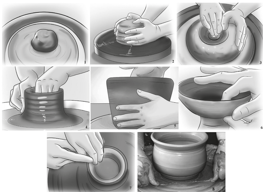
Obr. 7. Technika vytáčení na kruhu (dostupné z www.wikihow.com , www.pottery.about.com ).
