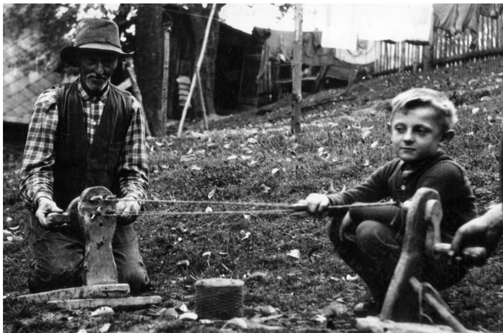
Obr. 12. Stáčení provazu na provaznickém vozíku. Fotoarchiv Muzea regionu Valašsko, Vsetín.
