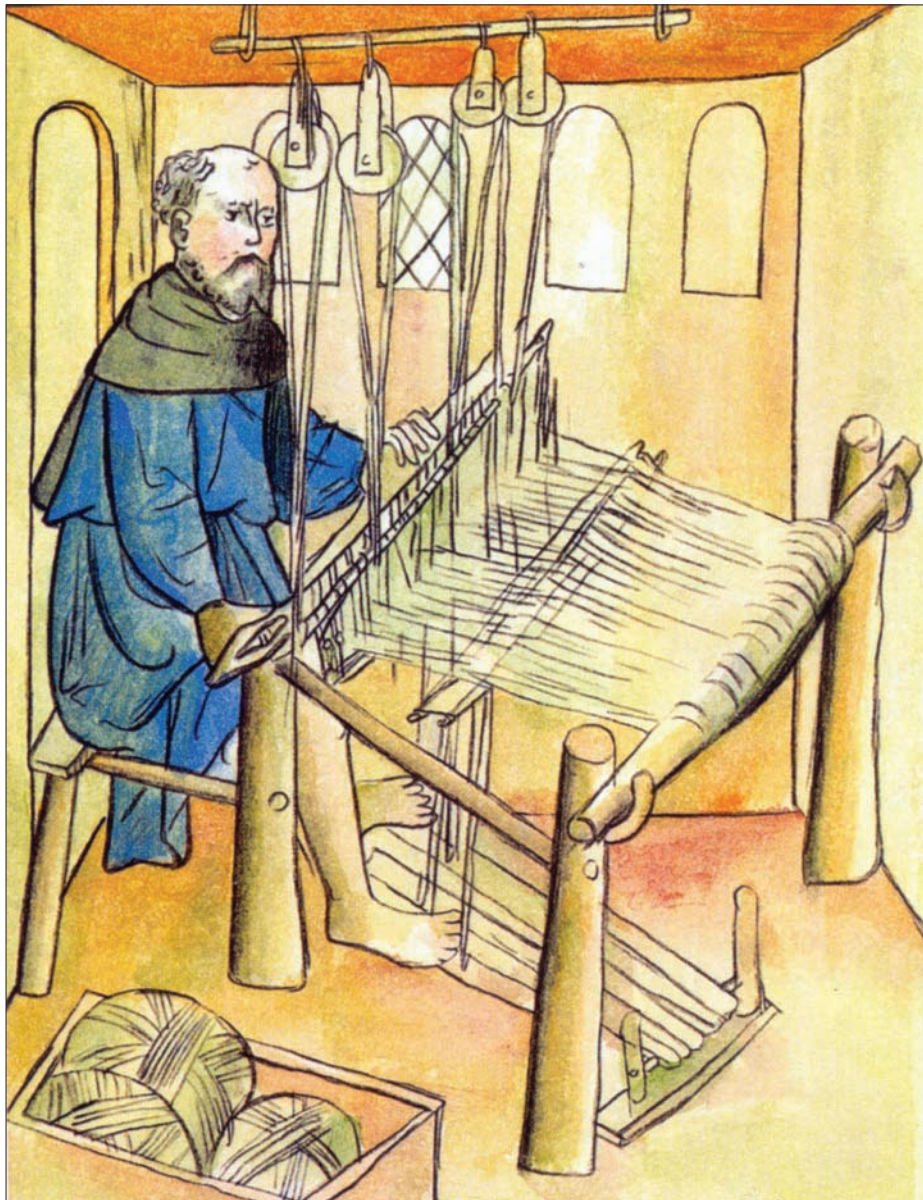
Obr. XXIV: Vyobrazení tkalce při tkaní na podnožkovém tkalcovském stavu z roku 1387, Hausbuch der Mendelschen Zwölfbrüderstiftung zu Nürnberg, Stadtbibliothek Nürnberg, Amb 317.2, fol. 4v (podle Maik 1988)
