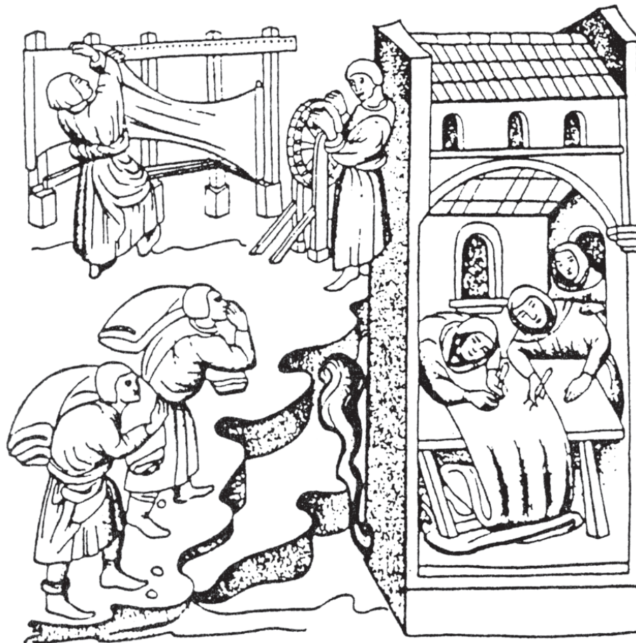
Obr. XXVII: Napínání zvalchovaného mokrého sukna na rám, zobrazené v levém horním rohu ilustrace v Historia ordinis humiliatorum z roku 1421 (podle Maik 2000)
