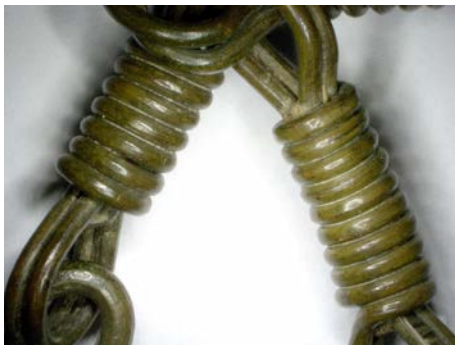
Obr. 8. Povrch závěsných spirálek se stabilní hnědo-zeleňou patinou korozních produktů mědi. Mikrosnímek z digitálního mikroskopu Keyence VHX.
