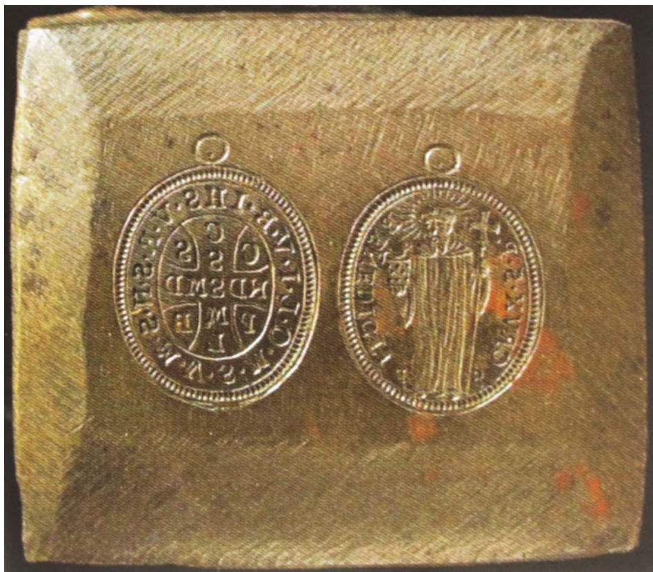
Obr. 9. Salcburskou masovou výrobou umožnila zmechanizovaná ražba pomocí kapsového stroje. Na vyobrazení je ukázka kolků pro tento typ ražby z dílny Petera a Paula Seelových. Podle Keller 2010, 92.
