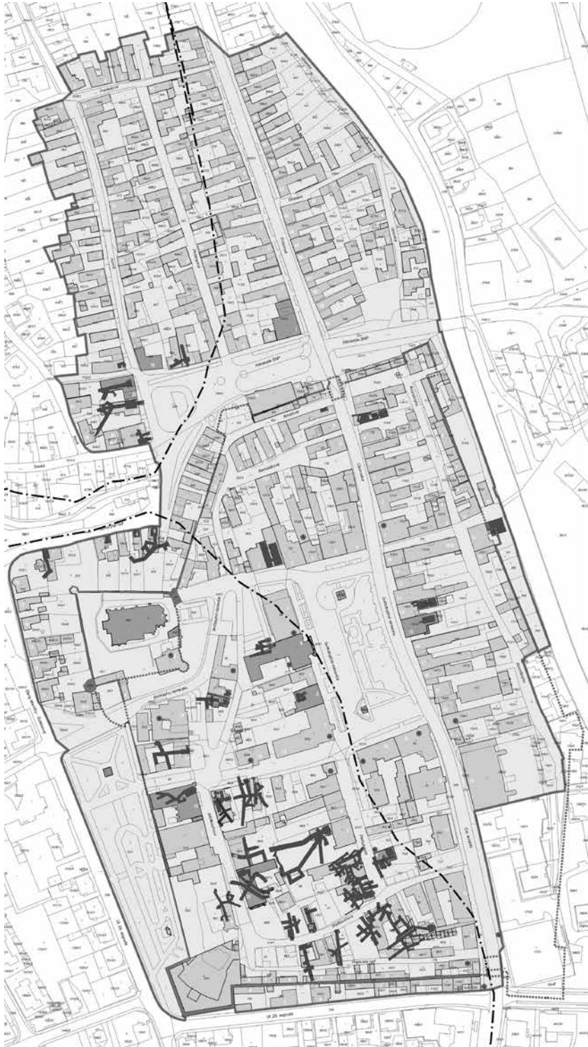
Obr. 8. Pamiatková zóna Krupina. Situácia kresaných pivníc v meste. Tmavou farbou – pôdorys pivnice, krúžok – neprístupná pivnica, bodkočiarkovane – geologické rozhranie. Zdroj: Geologická mapa SR, upravené podľa terénnych zistení. Zameranie M. Mišo a M. Fratričová, grafické spracovanie H. Kasová. Abb. 8. Denkmalzone von Krupina. Lage der in Stein gehauenen Keller in der Stadt. Dunkle Farbe – Kellergrundriss, Kreis – nicht zugänglicher Keller, punktiestrichelt – geologische Grenze. Quelle: Geologische Karte der Slowakei, modifiziert gemäß Geländeerfassung, Vermessung M. Mišo und M. Fratričová, grafische Bearbeitung H. Kasová.
