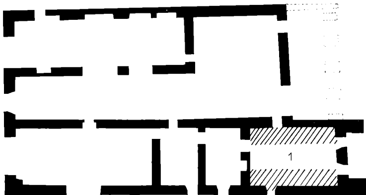
Obr. 3. Banská Bystrica, Nám. SNP č. 1 – prízemie. Šrafovaním vyznačený zásyp renesančnej klenby s deštrukciou neglazovanej kachľovej pece.
