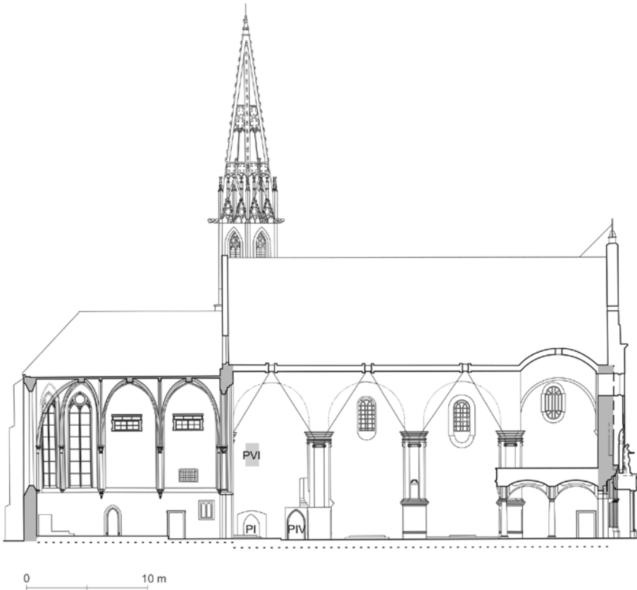
Obr. 4. Bratislava, františkánsky kostol, južný rezopohľad. P1–P1V – zachované stredoveké portály v južnej stene lode. PVI – pozícia priechodu smerujúceho z veže do lode. Zdroj Archív Pamiatkového úradu SR, Zbierka projektov a plánov, sign. A6630, Zbierka reštaurátorských dokumentácií, sign. R3727, 3429, 3485; upravené, doplnené.
