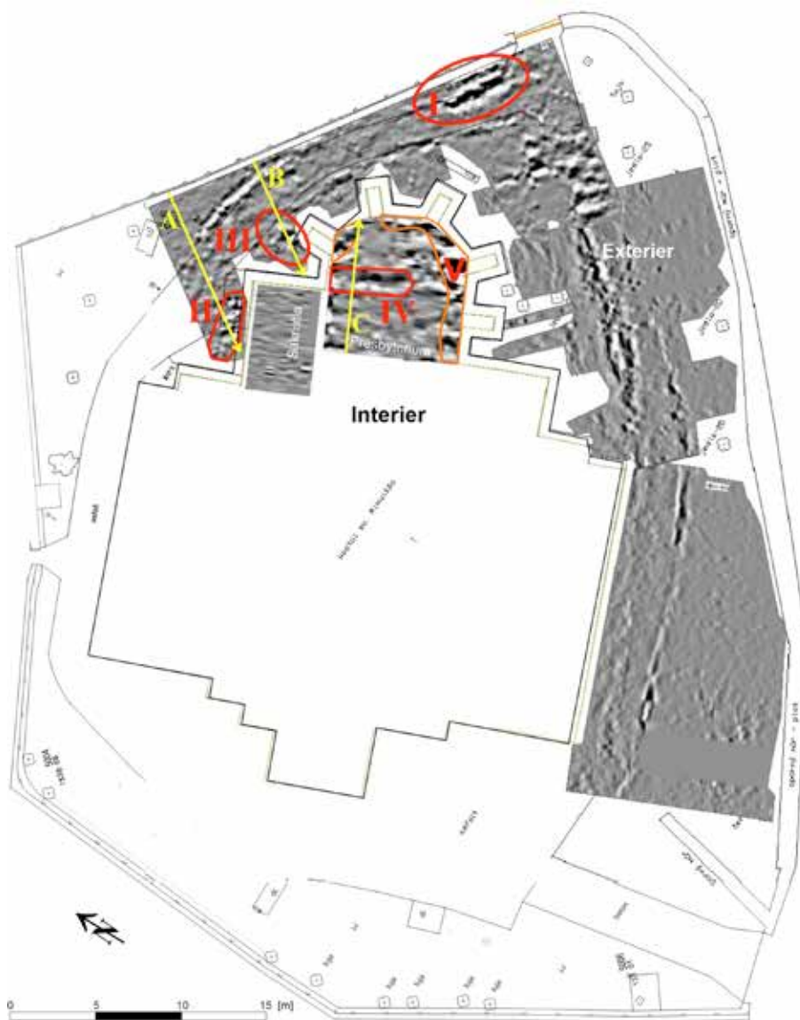
Obr. 10. Plán lokality s výsledkami GPR merania. Horizontálny GPR rez z hĺbky 100 cm s vyznačenou polohou vybraných GPR profilov (žltá farba) a s anomáliami archeologického významu (červená farba).
