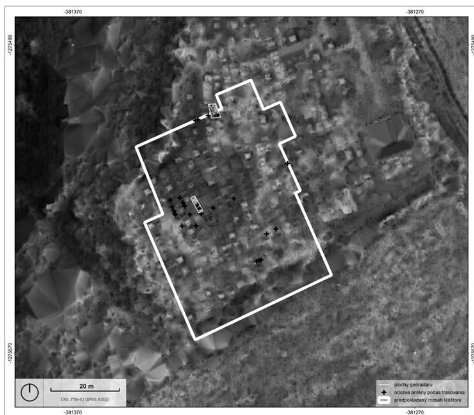
Obr. 10. Výsledky georadarového prieskumu (plochy 1 a 2 georadarového prieskumu, čierne krížik bodový záznam signálu antény georadaru) v Lučenci-Opatovej a ich možná interpretácia (bielou). Autor M. Felcan.
