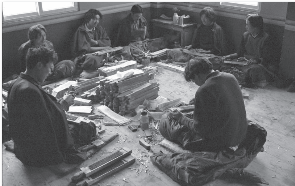
Obr. 3: Vyřezávání nových matic pro tištění knih (klášter Päljul, Kham, foto: autor 2007)
