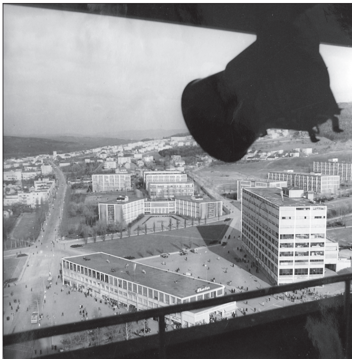
4. Rozhlasový amplion připevněný pod střechou 21. budovy (1942): „Hlas těchto tlampačů je tak mocný, že za dobré slyšitelnosti je možno jej slyšet na vzdálenost pěti kilometrů – a dokonce mu rozumět. Tento nejsilnější hlas Zlína je dokladem vyspělosti dnešní radiotechniky“ (mk, Místní rozhlas na pět kilometrů. České slovo , 18. 3. 1942).
