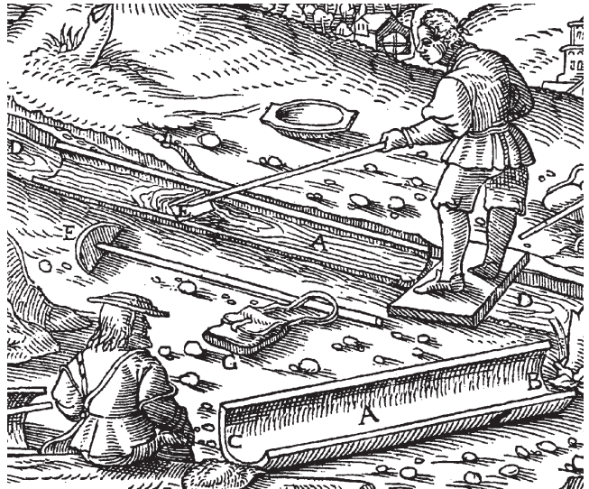
Obr. 81. Úprava vodního toku pro účely zpracování rud, popř. rýžování v 16. století. Tvarově a konstrukčně je shodná s nálezem podobných zařízení na středověkých Starých Horách. Podle G. Agricoly, 1556 (Ježek – Hummel 2001).
