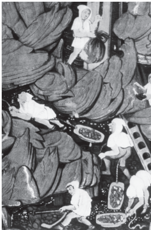
Obr. 6. Transport natěžené hlušiny, žiloviny a rudiny ve středověkých dolech v neckách podle Kutnohorského graduálu, poslední čtvrtina 15. století.
