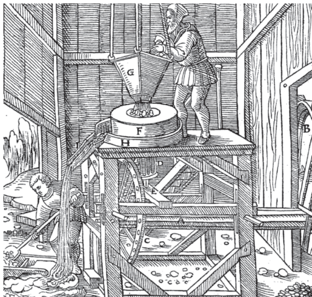
Obr. 15. Rudní mlýn poháněný vodním kolem, podle G. Agricoly, 1556 (Ježek – Hummel 2001).
