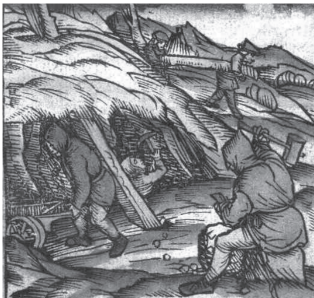
Obr. 5. Těžba v dole, ruční roztloukání rudy a vystrojování dolů. Dřevoryt z díla Ulricha Rülleina von Calv s názvem Eyn wohlgerechnet nützlich Büchlein, wie man Bergwerk suchen und finden soll, okolo roku 1500.
