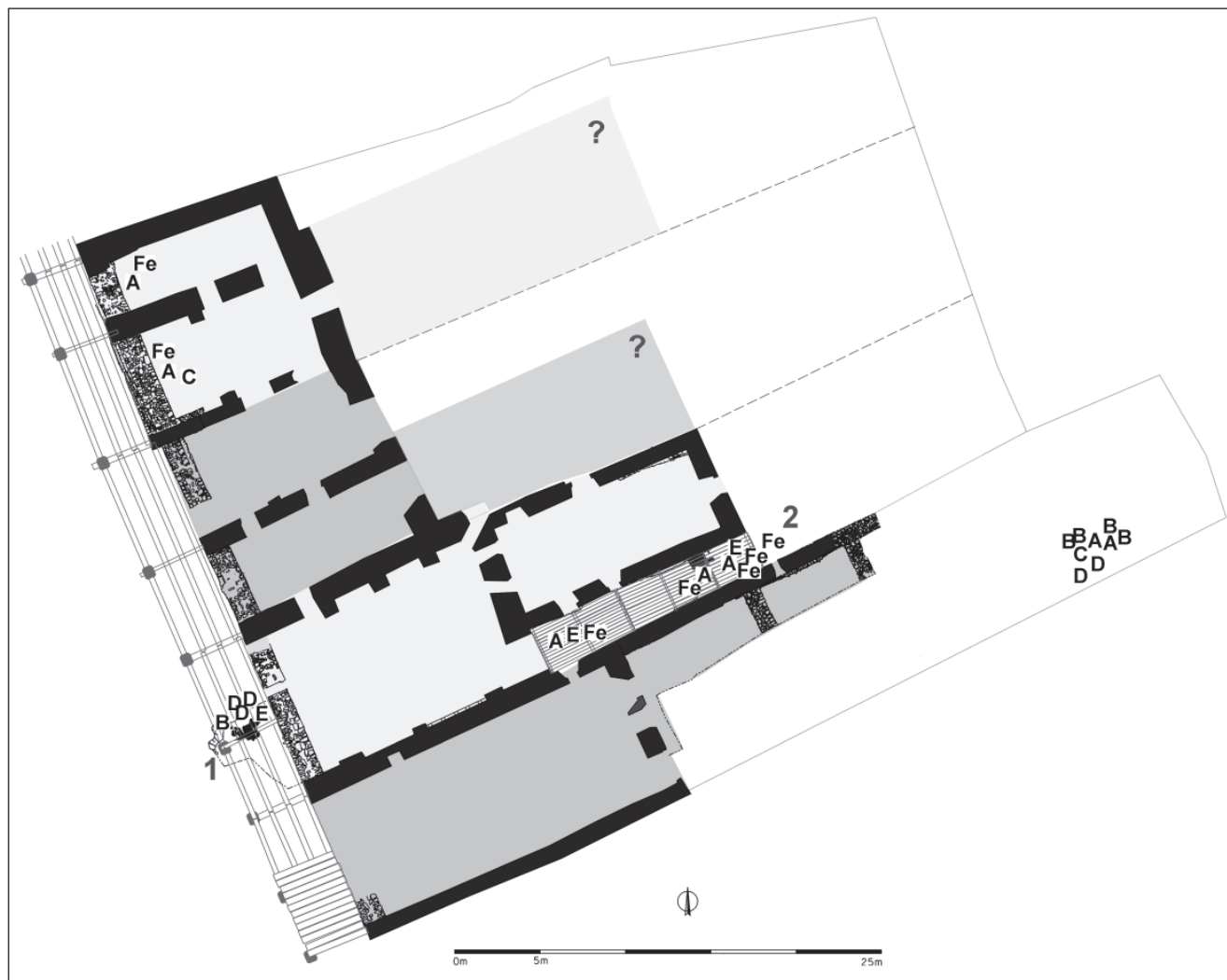
Obr. 250. Jihlava – Masarykovo náměstí 1 a 2 (radnice). Hypothetická rekonstrukce půdorysu měšťanských domů v areálu dnešního radničního komplexu ve třetí stavební fázi do roku 1300 s dřevěným plochostropým podloubím na základě archeologických nálezů. 1 a 2: segmenty zhroutčeného dřevěného stropu; A: strusky z hutnění barevných kovů; B: slitky a úkapky barevných kovů; C: fragmenty tepelně postižených stěn pecí; D: tavicí keramika; E: mince; F: kovářské strusky.
