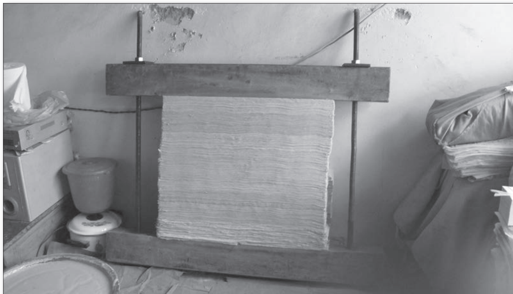
Obr. 6: Lisování knih před obarvením ořízky (Labrang, foto: autor 2007)
