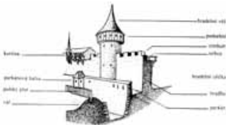
Obr. 9. Schéma opevnění města. Podle Petrůň a kol. 1985, obr. 365. Abb. 9. Stadtbefestigungsschema. Nach Petrůň und Koll. 1985, Abb. 365.
