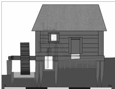
Obr. 15. Hypotetický model středověkého vodního mlýna pro oblasti se zvodněnými sedimenty v okolí řek. Jde o vodní obilný mlýn s vertikálním vodním kolem – lopatníkem na spodní vodu a obyčejným mlecím složením bez mechanického prosévání a bez lubu. Konstrukce objektu drážková, bez tepelné izolace. Autorka L. Galusová.
