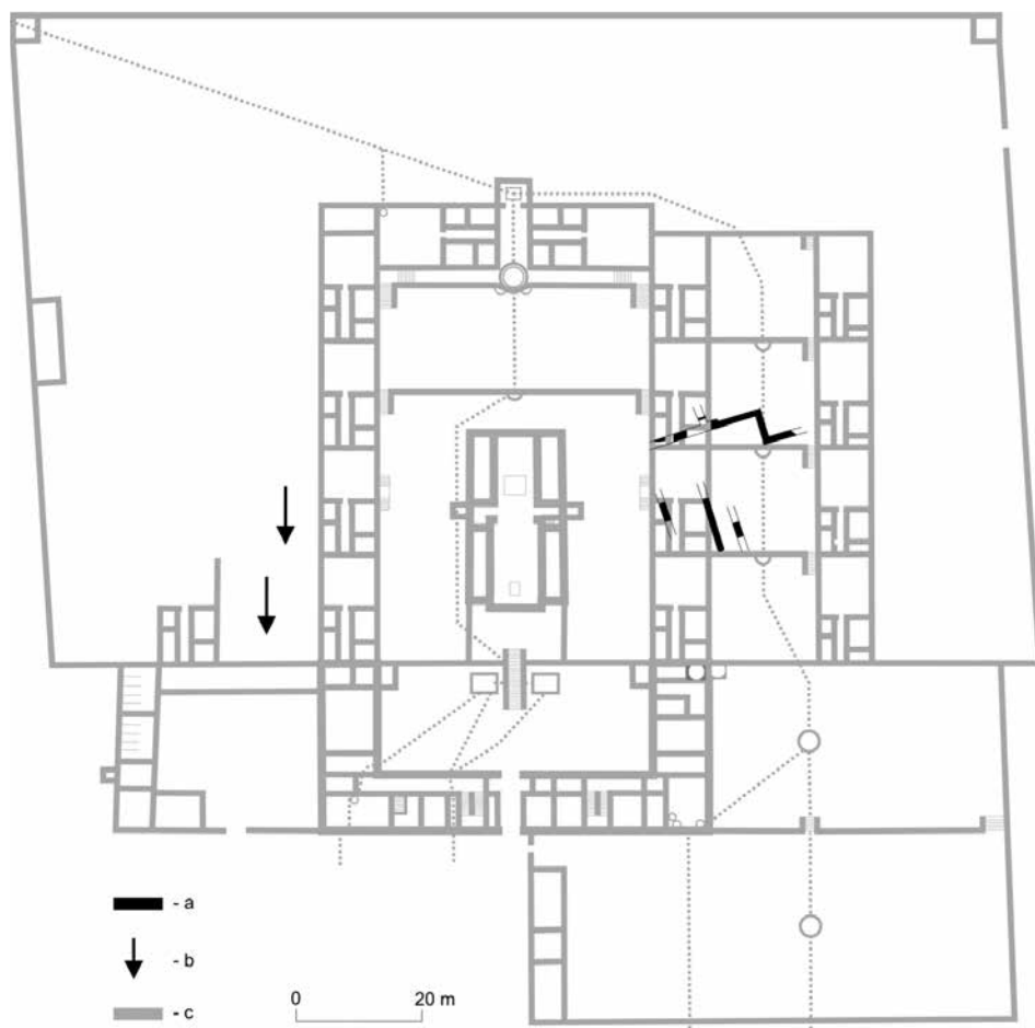
Obr. 2. Vrch Zobor pri Nitre, zaniknutý kláštor. a – archeologicky zachytené zvyšky stredovekého benediktínskeho kláštora, b – miesto ďalších stredovekých nálezov, c – pôdorys barokového kamaldulského kláštora. Autor plánu M. Samuel. Abb. 2. Berg Zobor bei Nitra, Untergegangenes Kloster. a – archäologisch erfasste Überreste eines mittelalterliches Benediktinerklosters, b – Ort weiterer mittelalterlicher Funde, c – Grundriss eines barocken Kamaldulsenklosters. Autor des Risses M. Samuel.
