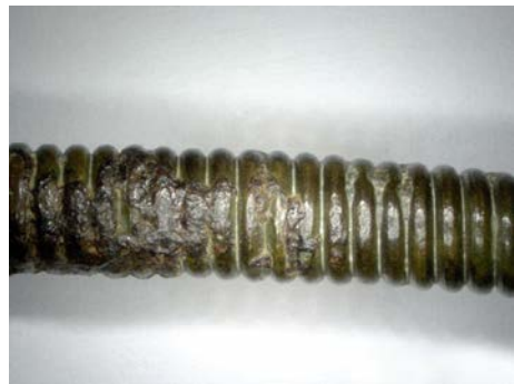
Obr. 9. Detail korozních produktů železa na povrchu spirálky řetízku. Mikrosnímek z digitálního mikroskopu Keyence VHX.
