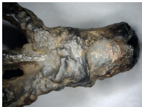
Obr. 10. Větší železný klíček se zbytky pájení mědi. Mikrosnímek z digitálního mikroskopu Keyence VHX. Abb. 10. Größerer Eisenschlüssel mit Kupferlötfragmenten. Mikroaufnahme von einem Digital-Mikroskop Keyence VHX.
