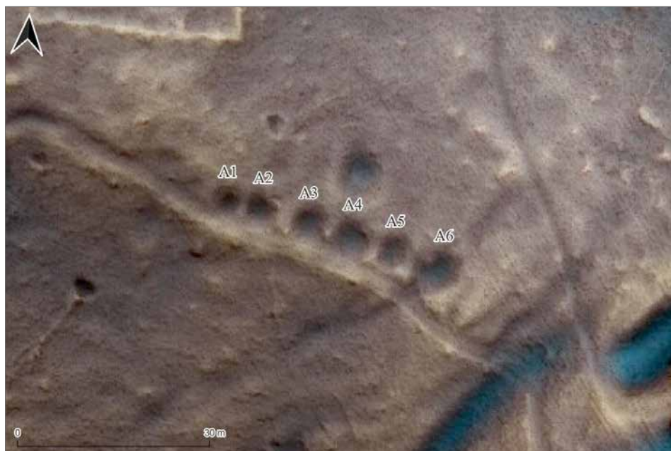
Obr. 4. Zahĺbené terénne reliktý (A1–A6) na digitálnom modeli terénu, ktoré možno stotožniť so šiestimi malými pecami spomínanými v hlavnej pokladničnej knihe z rokov 1539–1542. Zdroj produktov LLS: ÚGKK SR. Autor vizualizácie T. Lieskovský.
